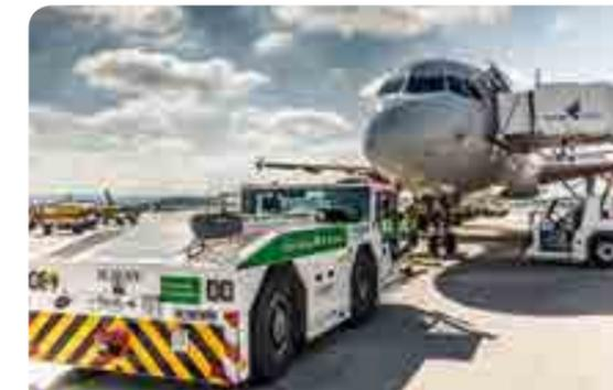
Der elektrische Flugzeugschlepper im Einsatz
