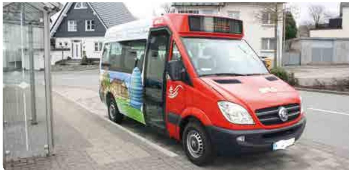
Elektrisch betriebener Minibus (Umbau; Basisfahrzeug Mercedes Sprinter)
