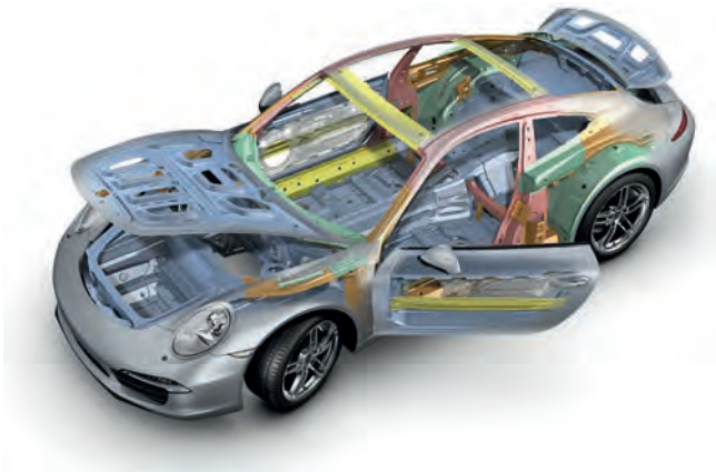
Abb. 5: Porsche 911, Leichtbaukarosserie mit intelligentem Werkstoffmix; © Porsche AG
