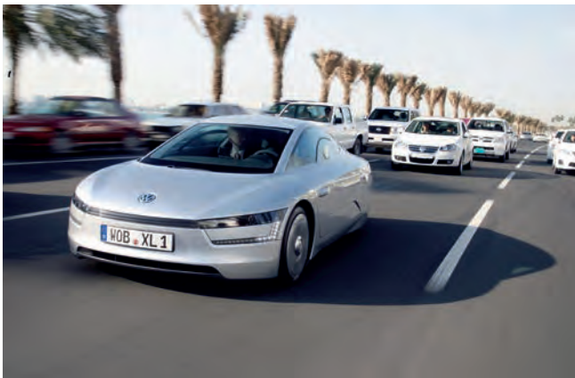
Abb. 2: VW XL1, Konzeptfahrzeug eines 1-Liter Automobils, 795kg Gesamtgewicht, CFK Karosserie; © Volkswagen Aktiengesellschaft
