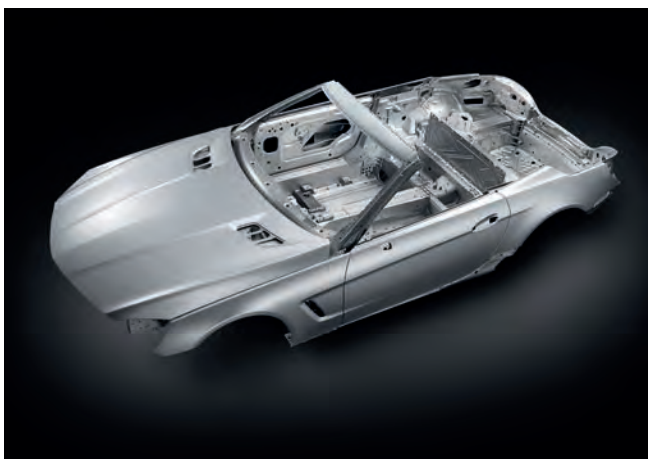
Abb. 6: Die Aluminium Rohkarosserie des neuen Mercedes-Benz SL wiegt 110 Kg weniger als die des Vorgängers und ist 20% steifer; © Daimler AG
