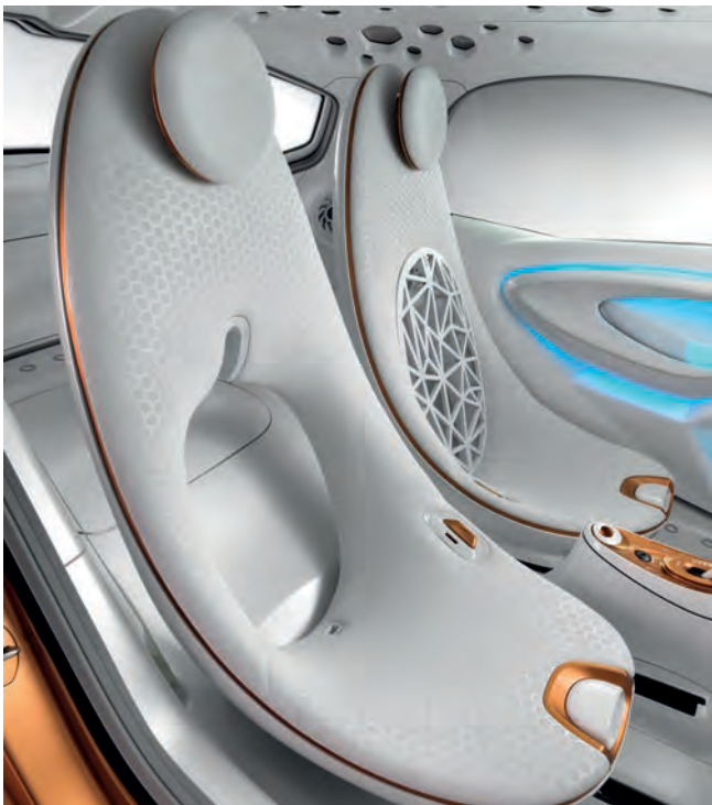
Abb. 8: Multifunktionale Kunststoff-Leichtbau-Komfortsitze im smart forvision; © Daimler AG
