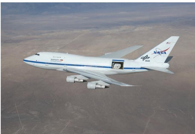
Abbildung 54 SOFIA mit geöffneter Teleskoptür in einer Flughöhe von etwa fünf km über der Mojave-Wüste (Kalifornien)<sup>117</sup>
