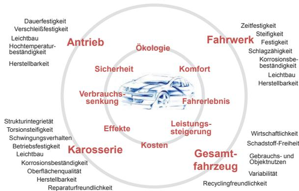
Abbildung 21 Unterschiedliche Anforderungen an die Module und Baugruppen im Automobilbau<sup>50</sup>
