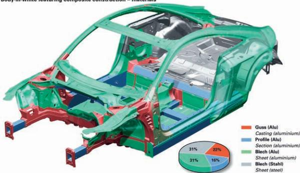
Abbildung 24 Multi-Material-Design am Beispiel der Karosserie des Audi TT<sup>56</sup>
