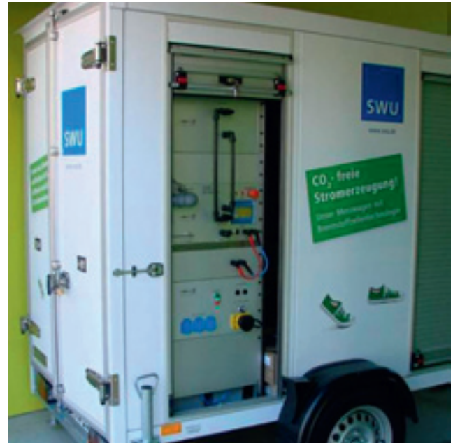
Abbildung 3.23: Messwagen der Stadtwerke Ulm mit BZ-Energieversorgung . Eigene Darstellung nach [UBZM].
