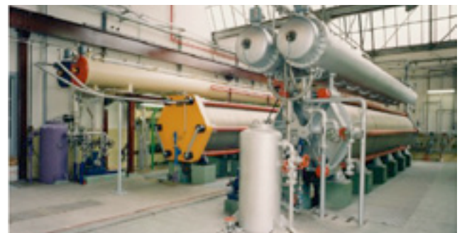
Abbildung 4.1: 111 kW atmosphärischer alkalischer Wasserelektrolyseur (links) und alkalische Druckelektrolyseanlagen nach dem Lurgi-Prinzip (rechts). Eigene Darstellung und 20 .
