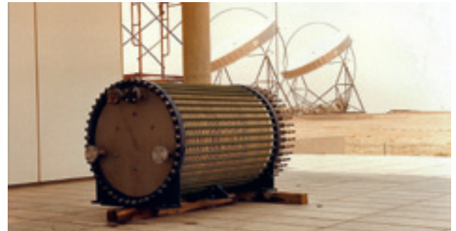
Abbildung 4.5: 140-zelliger Druckelektrolyseblock für den dynamischen Solarbetrieb. Eigene Darstellung.
