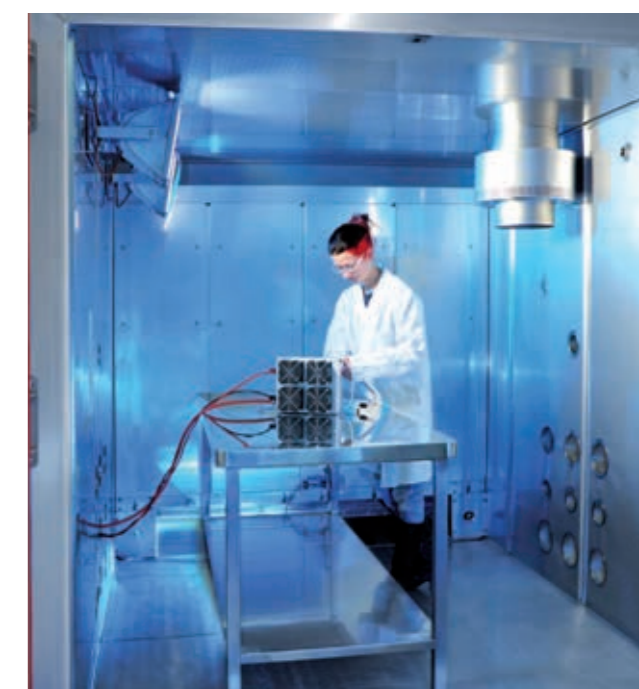
Abbildung 29: Klimaprüfzelle zur Untersuchung von Brennstoffzellen-Systemen am Fraunhofer ISE
