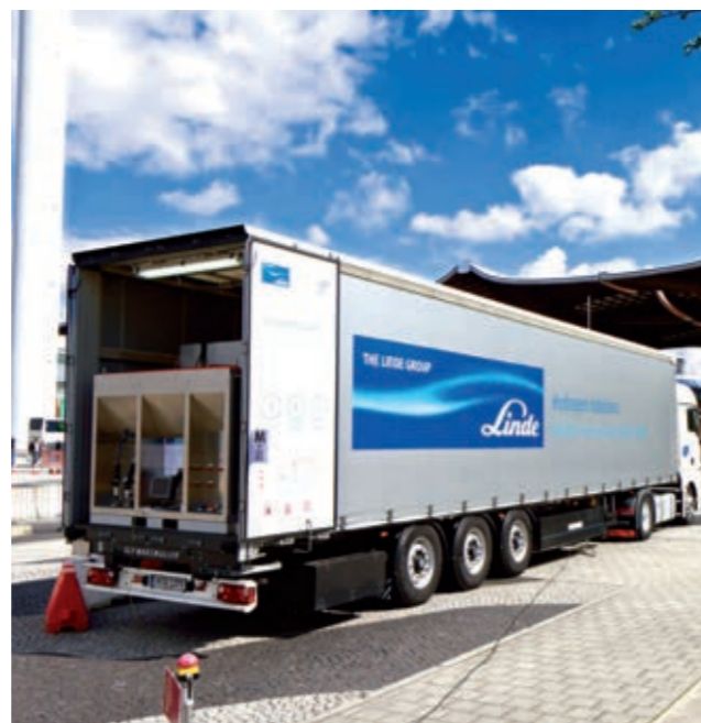
Abbildung 18: Lindes mobile Betankungsanlage trailLH 2 -gas auf der Hannover Messe 2012 (Quelle: Tobias Renz FAIR)
