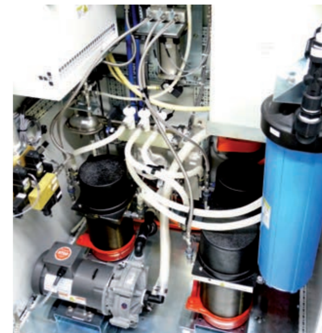
Abbildung 19: Onsite-Elektrolyse-Systeme PEM Elektrolyseur der Firma Proton Onsite (früher Proton Energy Systems) an der Wasserstoff-Tankstelle am Fraunhofer ISE, Freiburg (links: Verfahrenstechnischer Aufbau, rechts: Bedienpanel)
