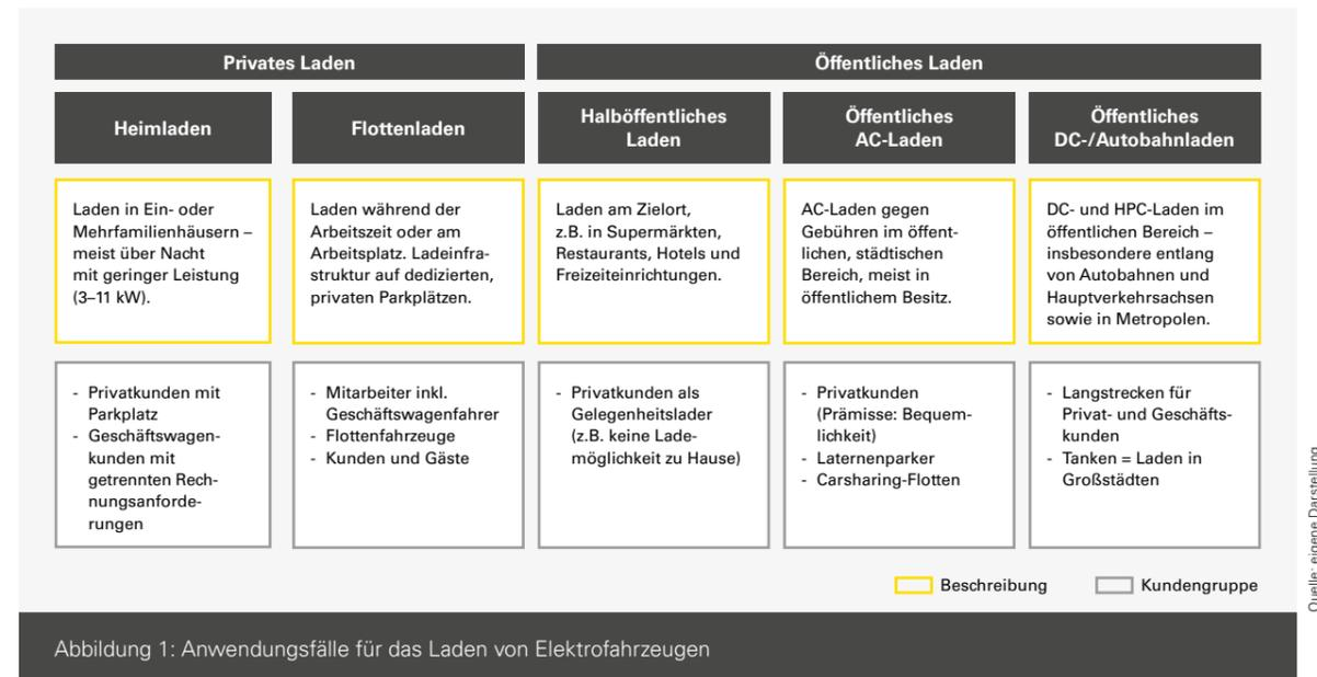
Abbildung 1: Anwendungsfälle für das Laden von Elektrofahrzeugen
